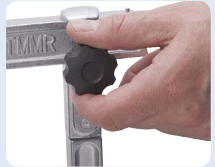
Los extractores de brazos extralargos tienen tornillos de fijación que asisten en el posicionamiento inicial de los brazos. Cuando se aplica un esfuerzo de extracción, la característica de autobloqueo asegura la posición del brazo en la viga.
